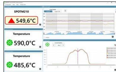
為用戶提供所有 SPOT 高溫計和執行器連接到網路的完整概覽，SPOT Pro 允許為每個使用自動觸發器儲存數據的溫度計獨立設置數據記錄。
